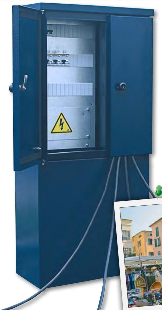
*Bals a conçu une armoire d'alimentation pour les marchés ou les aires de forains en prenant en compte les besoins de l'exploitant et des utilisateurs : bornes en tôle avec peinture polyester pour une résistance aux intempéries et un entretien minime, réalisation anti-vandale sans aucune visserie apparente, fixation au sol inaccessible une fois l'armoire montée, compartimentage entre protections et prises...*
