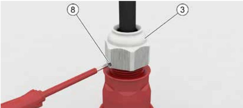
10. Veillez à ce que le câble soit solidement fixé dans le système de connexion électrique.
