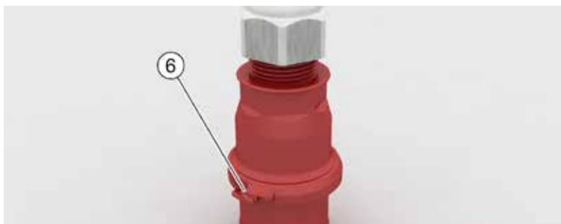
9. Serrez ensuite fermement le presse-étoupe (3). Pour les modèles 16 A, le couple de serrage doit être compris entre 4 Nm et 7 Nm ; pour les modèles 32 A, entre 5 Nm et 9 Nm. Relevez la valeur exacte selon le modèle de l'estampage sur le presse-étoupe. Sécurisez le presse-étoupe grâce à la vis fixée latéralement et prévue à cet effet (8 selon le modèle).
